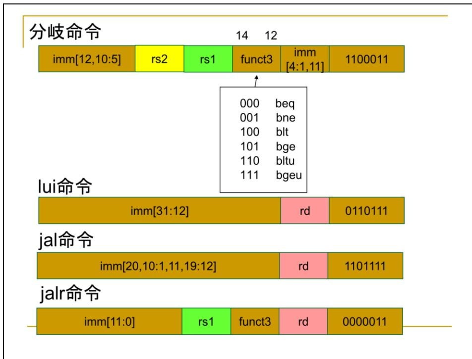
分岐命令は、飛び先を示すimmが分割され、ビット順が入れ替わっています。jal命令はビット順の入れ替わりのみ行われています。luiはjalと同じフィールドの配置ですが、bit順を入れ替えてはいません。jalrはイミディエイト命令と同じ並びです。
