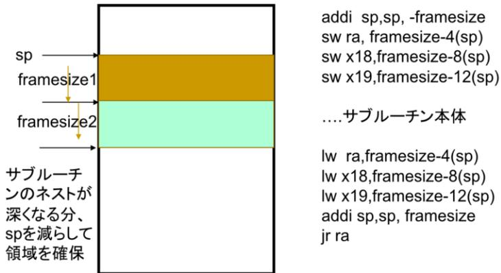
実際にスタックを作る場合の方法を示します。サブルーチンに入った時に、まずそのサブルーチンに必要なレジスタを数からフレームのサイズを計算し、その分スタックポインタを減らします。そしてその領域内にレジスタを格納して行きます。ここではディスプレイメントが威力を発揮します。サブルーチンの実行が終わったら、レジスタを復帰し、スタックポインタをフレームサイズ分だけ加えます。最後にjr (jalr)でメインルーチンに戻ります。この方法は、サブルーチン内で別のサブルーチンを呼ぶとその分spが下に下がり、リターンすると上がります。
